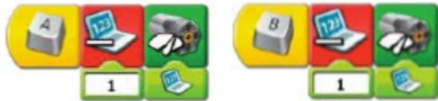
I due programmi sono simili e sottraggono 1 al Display diminuendo la velocità del motore. Funzionano premendo la lettera A o B.
