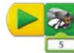
Nel programma puoi aumentare o diminuire la velocità del motore cambiando il valore. In questo caso basta modificare il valore 5 nell'etichetta sotto il motore (clicca sopra o scrivi un altro valore tra 0 e 10).
