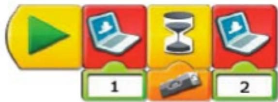
Al via viene presentato il primo sfondo nel display, poi il sensore di inclinazione aspetta che lo inclini verso l'alto e fa vedere il secondo sfondo.
