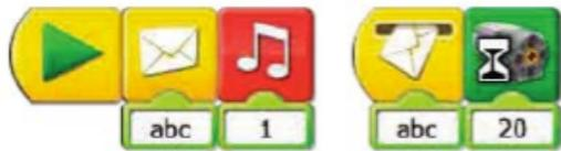
I due programmi funzionano insieme: il primo invia un messaggio e il secondo riceve il messaggio e fa funzionare il motore per 2 secondi.
