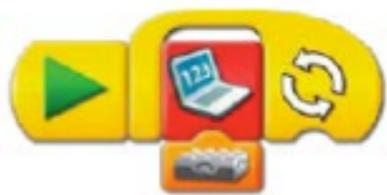
Il programma mostra il valore del sensore di inclinazione nel display, come cambi l'inclinazione cambierà il valore nel display.
