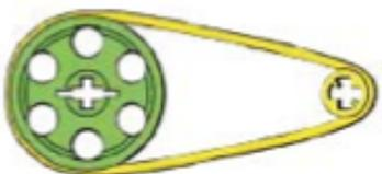
Le pulegge si muovono a velocità diverse nella stessa direzione. La seconda puleggia si muove più velocemente perché è più piccola.
