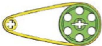
Le due pulegge si muovono nella stessa direzione a velocità diverse perché diversi sono i diametri. La velocità della seconda puleggia è minore.
