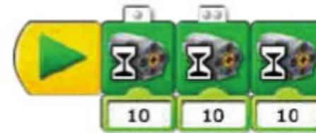
Nell'esempio vedi due motori etichettati con un pallino e due pallini per programmarli separatamente.
