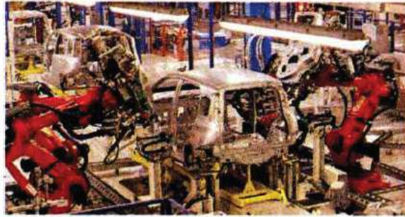
La "cella ad alta densità" OpenGate installata nello stabilimento Fiat-Fca di Pomigliano d'Arco. I robot Comau effettuano, nell'immagine, attività di saldatura
