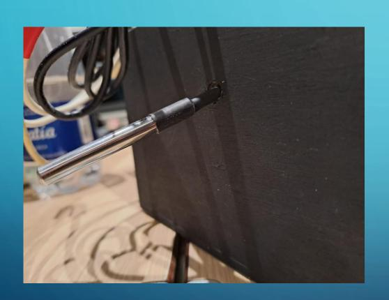
Il primo sensore utilizzato è una pt100 e verrà sfruttato per monitorare le temperature delle acque e i suoi relativi cambiamenti.
