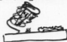
SUPPORTO PER SALDATORE CHE HA INCORPORATA ANCHE UNA SPUGNA DA BAGNARE PER LA PULIZIA DELLA PUNTA DEL SALDATORE. TI COSTERA' SUI 5€.
