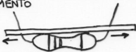
PER POTER SALDARE, INSERISCI IL COMPONENTE NEI REOFORI, RIGIRA LA BASETTA E PIEGA I TERMINALI DI CIRCA 45°, AFFINCHÉ IL COMPONENTE NON FUORIESCA DAI FORI DURANTE LA SALDATURA.
